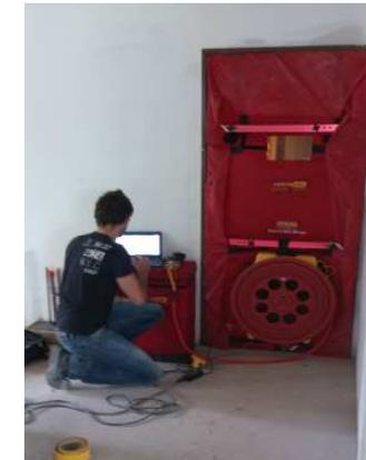
Mesure de la perméabilité à l'air
