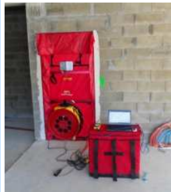
Mesure de la perméabilité à l'air
